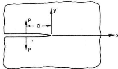
FIG. 7 SEMI-INFINITE CRACK UNDER WEDGE FORCES
